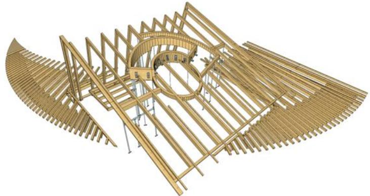
Die Graf & Kübler GmbH & Co. KG hat die Konstruktionsvollholz MH Fix® Sparren für das gewölbte Dach über dem EG sowie die geraden BSH- Sparren für das asymmetrische Satteldach im DG geliefert. Weiterhin wurden die, in Grund und Höhe geschwungenen BS-Hölzer, welche einen Wasserspeicherturm umschließen, konstruiert und geliefert.
