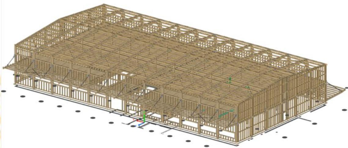
Winter 2016: Einer unserer schweizer Stammkunden hat uns den Auftrag für den Abbund und die Lieferung der Brettschicht-, DUO- und Konstruktionsvollhölzer, zum Neubau einer ca.57m x 30m großen Lagerhalle erteilt.
