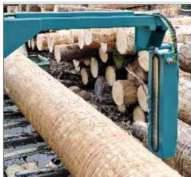
Das Abfahren und Vermessen des Stammes erfolgt automatisch in beide Richtungen möglich.
