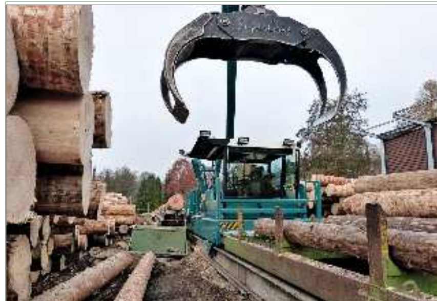
Auf dem angehängten Wagen legt der Bediener Stämme für die als nächstes zum Einschnitt anstehende Bauholzliste ab. Von hier legt er sie direkt auf die Aufgabe für die Sägelinie.
