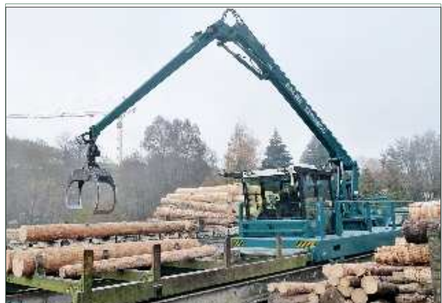
Gesamtansicht des Rundholzsortier- und transportwagens (RSTW) von Baljer & Zembrod auf dem Gelände des Holzwerks Kübler in Haiterbach
