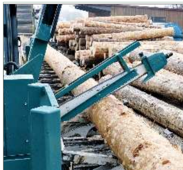
Zum Kappen wird der Stamm auf dem Bearbeitungstisch angehoben, links oben der Arm mit dem Signierkopf.
