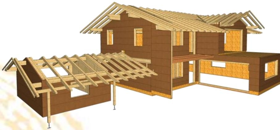
Sommer 2017: Wandelemente, außen mit Steico protect und innen mit OSB- (Haus) bzw. 3S- Platten (Garage) beplankt, verlassen auf zwei Wechselbrücken den Schwarzwald in Richtung Rosenheim.
